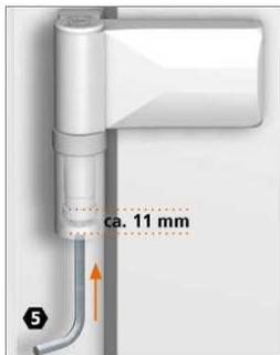
Aufheben + 4 mm, Herunterlassen - 3mm. Einstellung in vertikaler Richtung soll immer nur mit guterhaltenem Inbusschlüssel geleistet werden. Den Schlüssel stecken Sie voll im Band (ca 11 mm).
