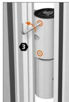
Lösen Sie die Schrauben ca um  $\frac{1}{2}$  der Umdrehung
