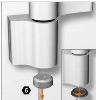
Entfernen Sie die untere Abdeckkappe. Die Einstellungsschraube stellen Sie nur an dem entsprechenden Band. Die Bänder stellen Sie schrittweise ein.
