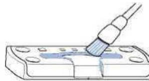
Um die Leichtgängigkeit der Beschläge zu erhalten, müssen die Schließbleche einmal jährlich geschmiert werden.
